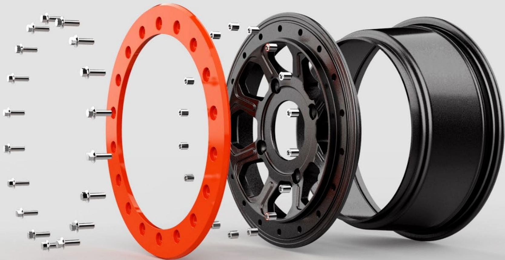
区别于传统铝轮铸造加工工艺，我们采用摩擦焊接技术，将铝板滚压的轮辋和低温铸造的轮辐进行组合，从而大幅减轻车轮重量，提升车轮的抗冲击能力，减少生产能耗和污染。
