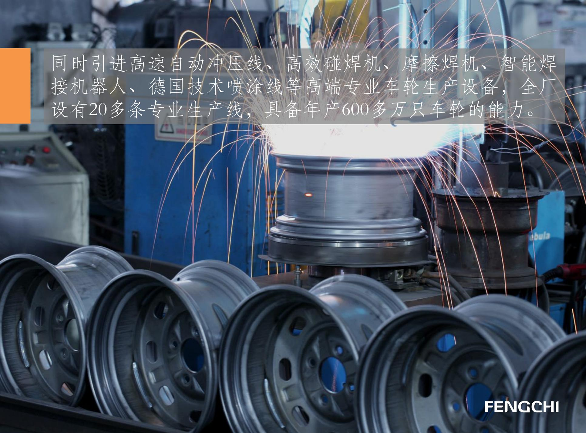
同时引进高速自动冲压线、高效碰焊机、摩擦焊机、智能焊接机器人、德国技术喷涂线等高端专业车轮生产设备，全厂设有20多条专业生产线，具备年产600多万只车轮的能力。
